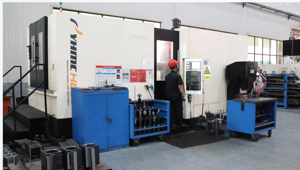
4 台卧式加工中心，可提供各类中小型精密座类、箱体类加工。
