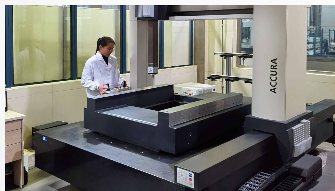
拥有德国蔡司三坐标检测仪、光学准直仪等高精度检测设备，所有量检具， 每年定时邀请第三方检测机构进行校验。
