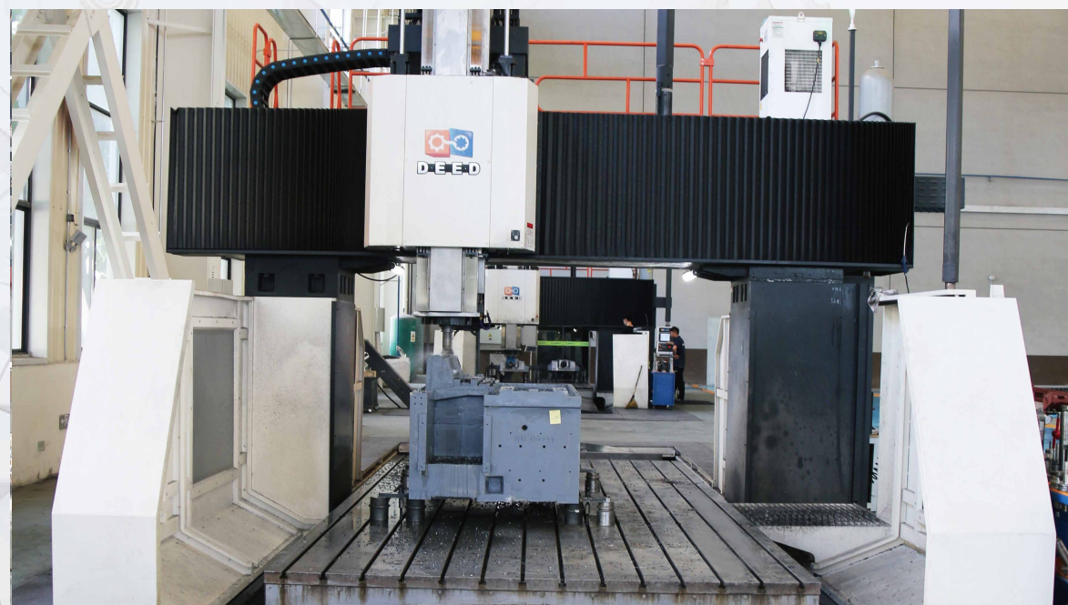
2 台 10 米龙门，可提供 10 米 × 4 米 × 2.4 米内的大型零部件加工； 6 台 9 米以下龙门，3 米 / 3.5 米 / 4 米 / 6.5 米 / 9 米。
